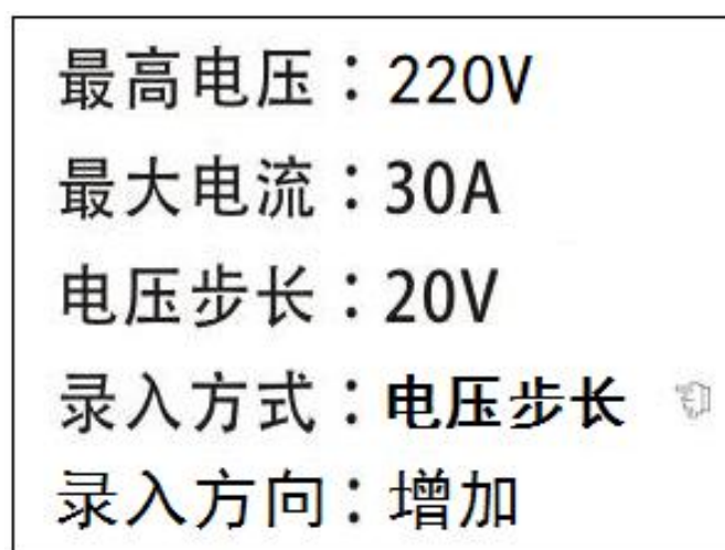
图 6-20 单相变压器空载试验设置
